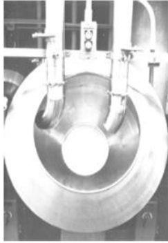
Hình 11.1. Nồi bao kinh điển với hệ thống thổi và hút khí.
