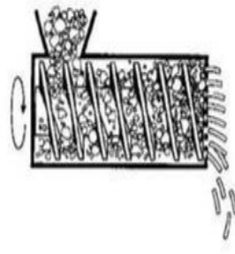
Hình 10.20. Nguyên tắc hoạt động của máy ép đùn
